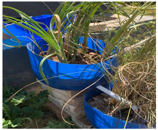
Fig. 56 Planter au fond de ce second récipient la plante typholatifolia dans cette étape les eaux usée qui sont filtrées s'acheminent au 3eme récipient
