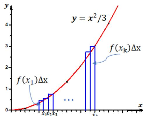
La surface des rectangles recouvre approximativement la surface S, plus les largeurs des rectangles  $R_k$  sont petites, plus l'approximation est bonne.
